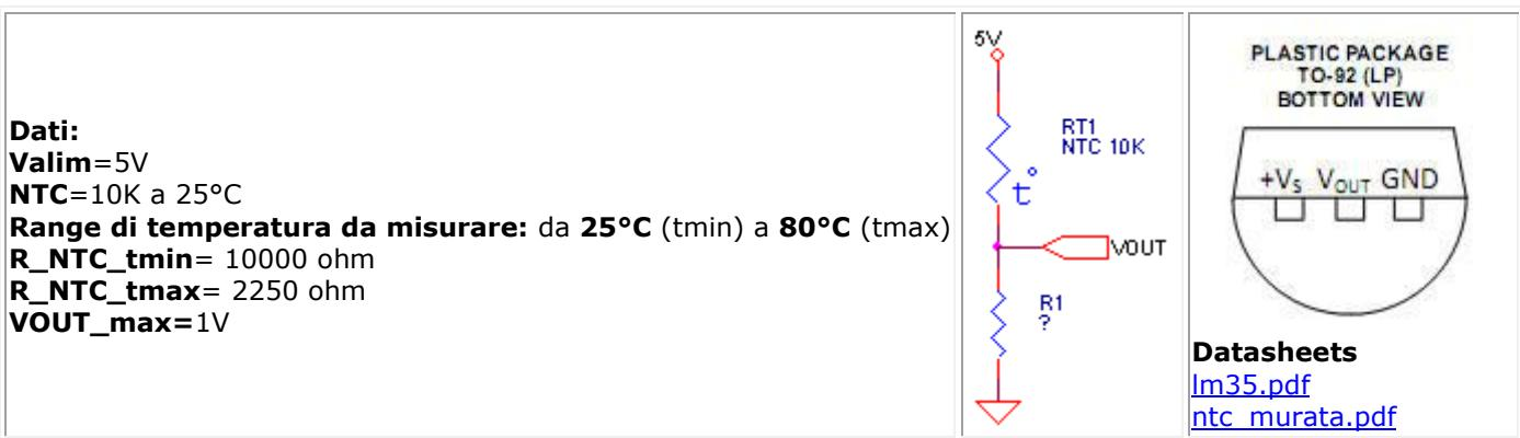
Siccome la scheda Arduino è stata impostata da programma per leggere al massimo una tensione di 1.1V progettiamo R1 per ottenere la massima tensione su VOUT in corrispondenza di tmax.
